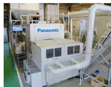
3種の樹脂を同時に選別できる近赤外線樹脂選別機
