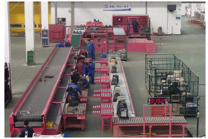
PDSHに新たに導入されたテレビ解体ライン
